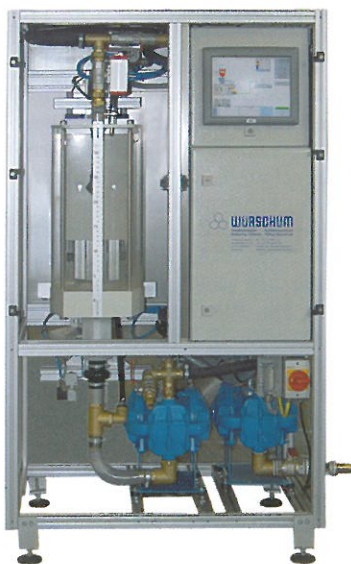
Mobile Flüssigfarbwaage Type KFW 25 mit integrierter Touchpanel Steuerung
